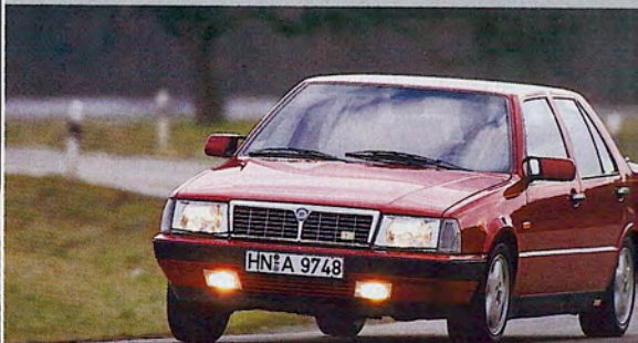
Ein Ferrari-Motor im Tipo 4-Gewand lässt aufhorchen. Der LANCIA THEMA 8.32 tauschte den Europa-V6 gegen den legendären Dreiliter-V8 mit 215 PS
