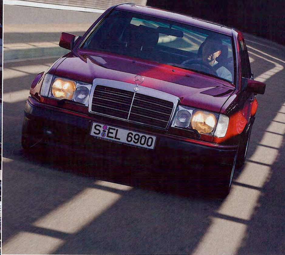
Eindrucksvolle Frontpartie mit Fernscheinwerfern neben dem Kühlergrill und Nebelleuchten im Frontspoiler. Geschmiedete Acht-Zoll-Räder. Imposanter Fünfliter-Vierventil-Achtzylinder aus Aluminium mit 326 PS
