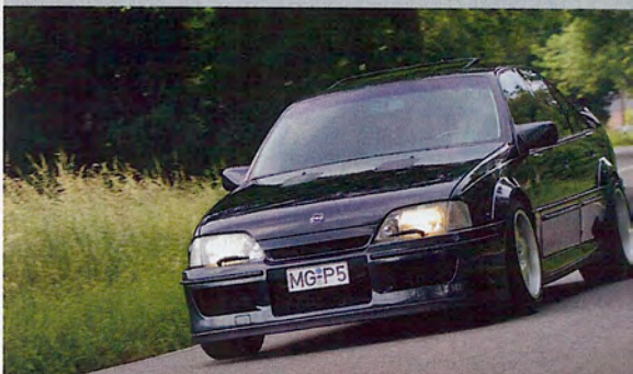
Bestialisch schnell beschleunigte der 3,6-Liter-24V Biturbo-Sechszylinder den brachialen OPEL LOTUS OMEGA . Spitze 282, 0-100 in 5,4 s
