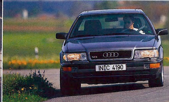
Achtzylinder im Mittelklasse-Kleid. Auch der AUDI V8 zelebrierte ab 1988 den leisen Luxus. 3,6-Liter-V8, 250 PS, Allradantrieb, ZF-5-Gang oder Automatik
